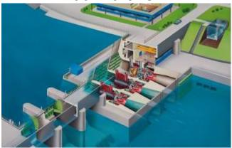
Laufkraftwerke nutzen das Wasser von grösseren Flüssen zur Stromproduktion. Damit ein Gefälle ausgenutzt werden kann, wird ein Stauwehr gebaut, welches das Wasser in der Regel über mehrere Kilometer zurückstaut.
